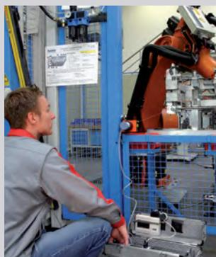
Только в том случае, если минимальное расстояние соответствует времени работы по инерции, гарантируется прекращение опасного движения машины до того, как в опасной зоне могут находиться люди. Наши технические специалисты на месте выполняют измерения инерционного выбега с помощью самых современных приборов, рассчитают безопасные расстояния для защитных устройств и внесут результаты измерений в протокол.
